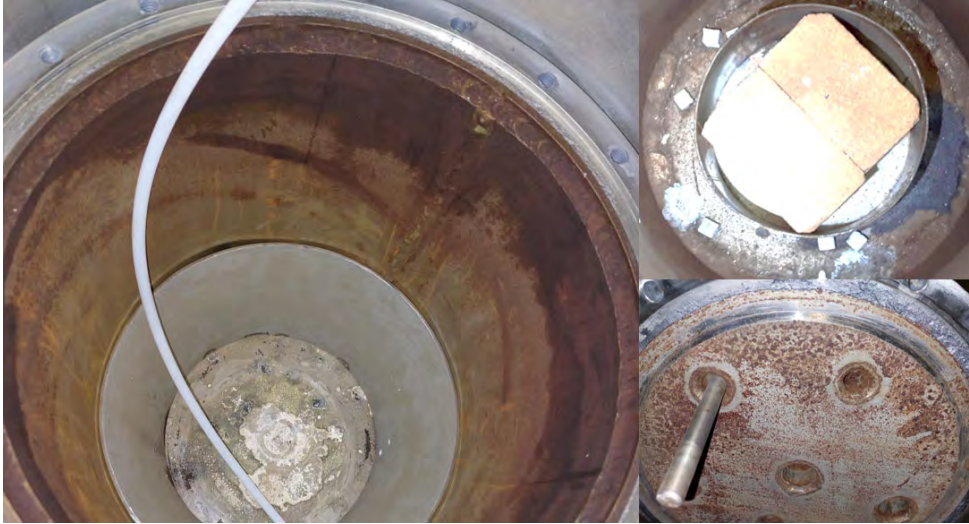
KUVA 31. Korroosio reaktorin eri osissa.
