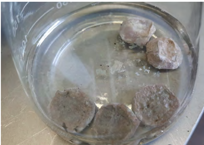
KUVA 19. Koeajon jälkeen säilötyt natriumit.
