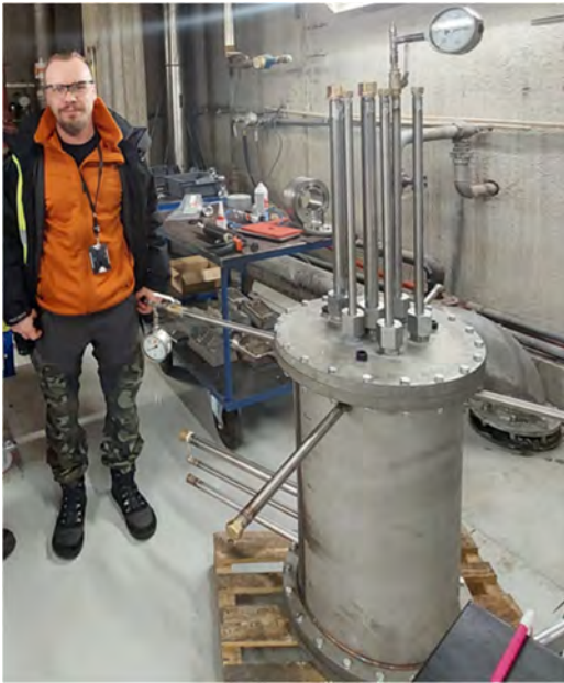
KUVA 5. Reaktorin painekoe HT Laser Oy:n tiloissa.
