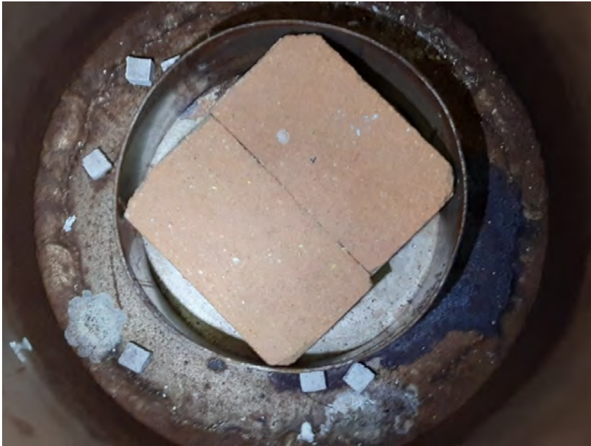
KUVA 16. Arinan ohitse pudonneet natriumpelletit.
