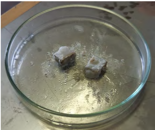
KUVA 10. Reaktorista poistetut natriumit. Natriumin pinnassa havaittavissa valkeaa suolaa.
