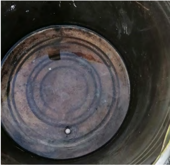
KUVA 11. Reaktoriin syötetyt natriumit ovat edelleen koeajon jälkeen reaktiivisia veden kanssa.
