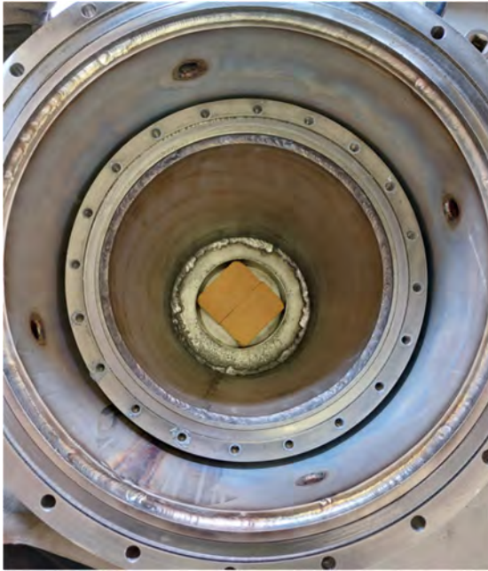
KUVA 2. Reaktori kuvattuna sisältä ilman kansia ja arinaa.
